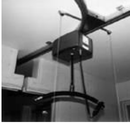
Transito attraverso una porta normale con apertura a muro per il motore
